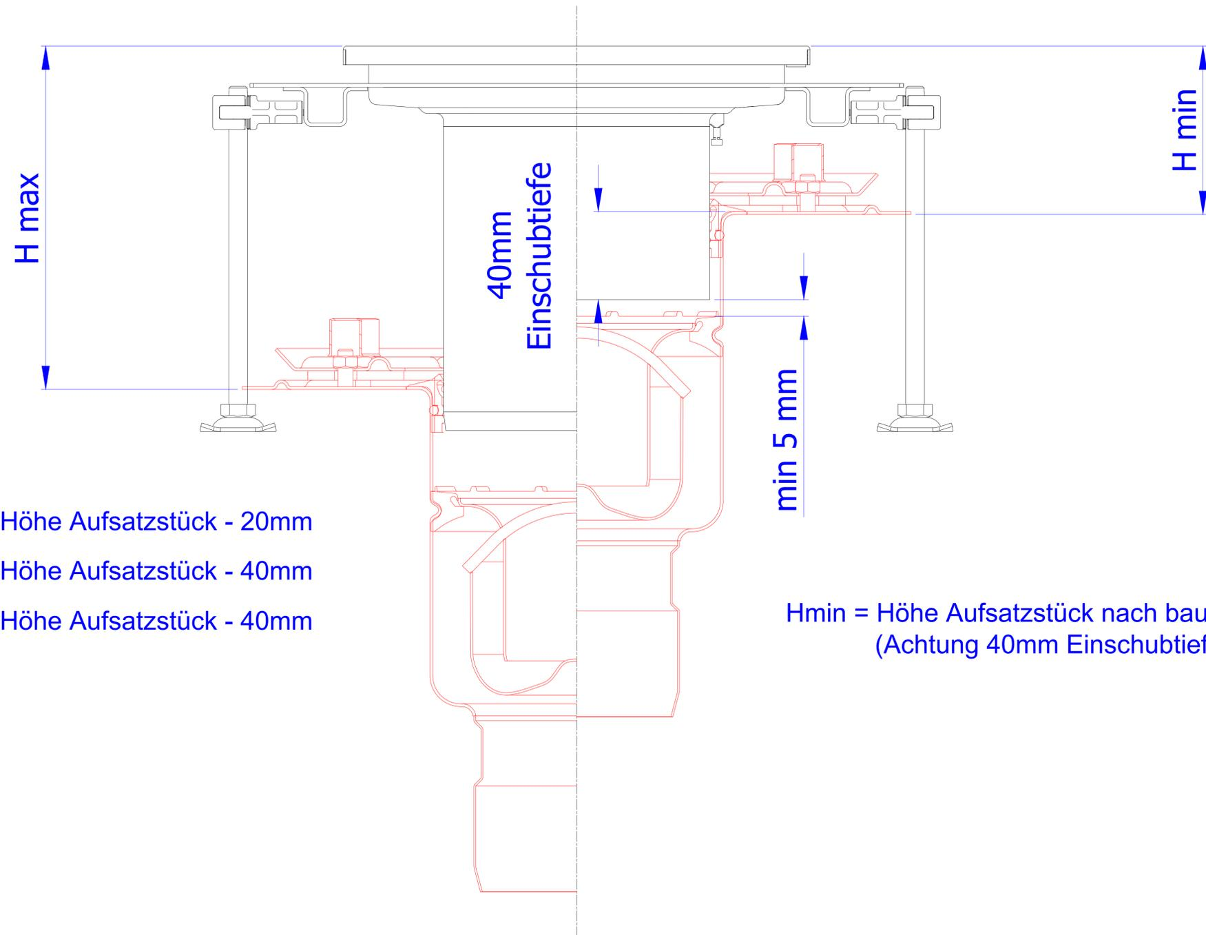
Ablauf Typ 142  $H_{max} = \text{Höhe Aufsatzstück} - 20\text{mm}$
