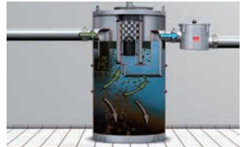
Funktionsprinzip: Leichtflüssigkeit sammelt sich im Abscheider an der Oberfläche und Schwerstoffe (Schlamm) sinken zu Boden.
