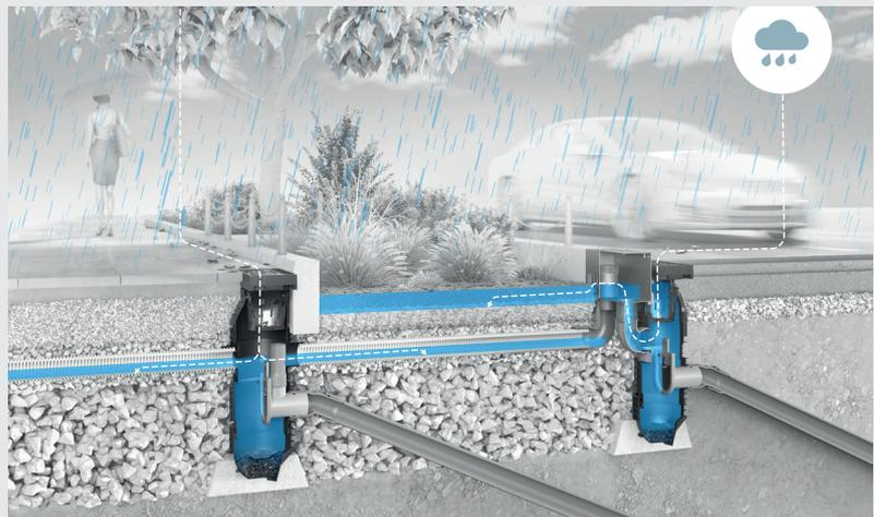
Abbildung 1: Sommerbetrieb - Schieber geschlossen
